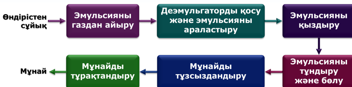
Сурет 1. Мұнайды дайындау қондырғысының технологиялық құрылымы
